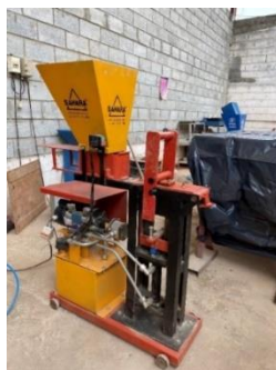
Figura 2: Prensa hidráulica modelo Professional HM da empresa Jarfel/Sahara
