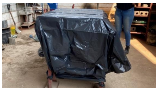
Figura 4: Início do processo de cura dos tijolos Fonte: Autora (2021)
