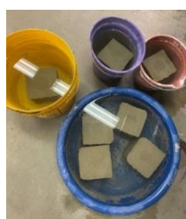
Figura 6: Imersão dos tijolos ecológicos após o endurecimento da pasta de cimento
