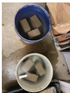
Figura 9 – Imersão de 24h dos tijolos (ABNT NBR 8492, 2012) Fonte: Autora (2021)
