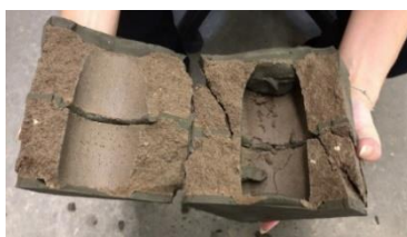
Figura 8: Rompimento do tijolo ecológico com argila expandida Fonte: Autora (2021)
