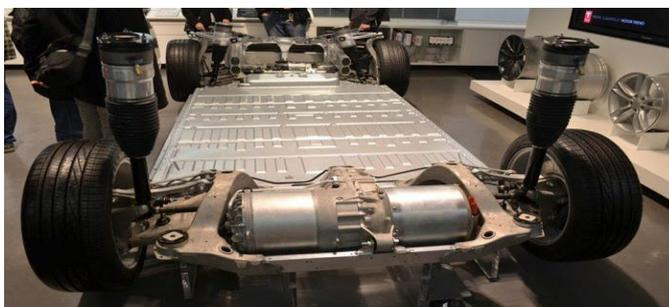
**Figura 2** - Chassi carro Tesla modelo 3 (VEB)
